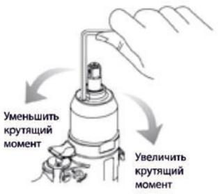
Требуемый крутящий момент можно легко отрегулировать, поворачивая регулировочный винт через отверстие в корпусе импульсного блока
